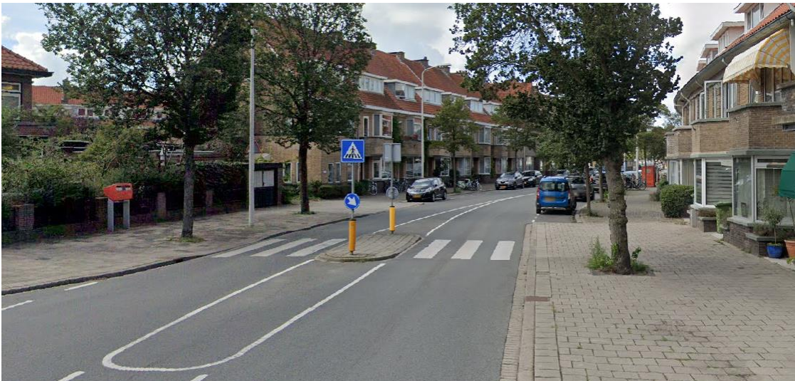
Midblockoversteekplaats met VOP-markering, zonder geleidelijn
