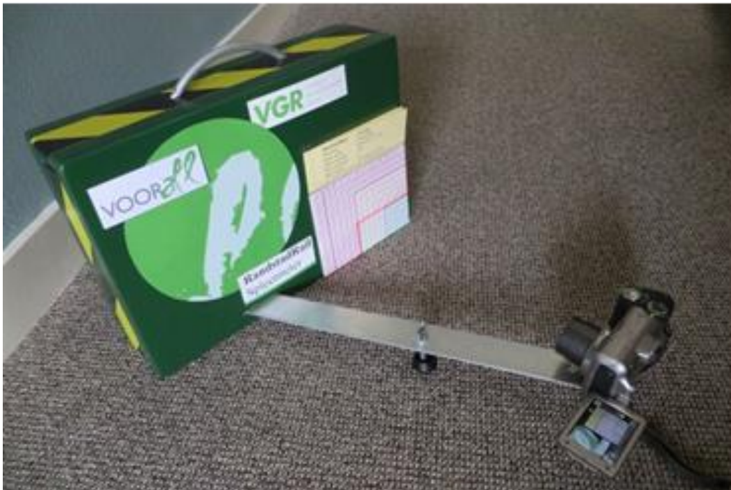
De gebruikte perron / voertuig spleetmeter
