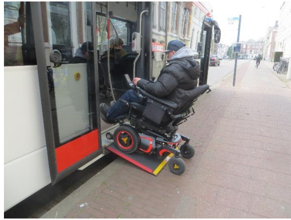
halte ligt te laag en komt uit op het fietspad
