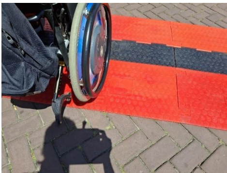
Voorbeeld van de speciale rolstoel toegankelijke kabelgoten.
