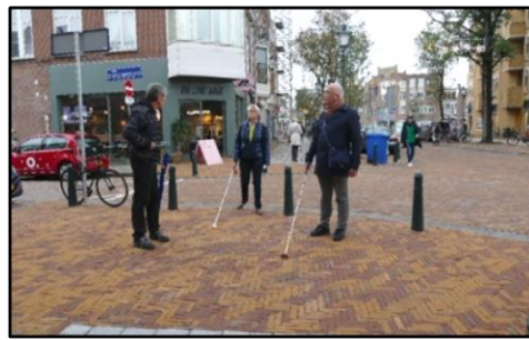
'Vergevingsgezinde' trottoirbanden op de hoeken
