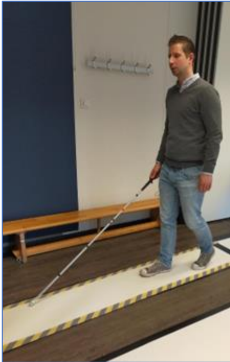
Geleidelijn gemaakt van driedubbelgevouwen stucloper met reliëftape aan de zijkanten.
