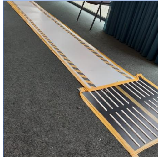
Looproute via de geleidelijn, waarbij opvalt dat de starttegel niet direct achter maar rechts van de voordeur ligt.
